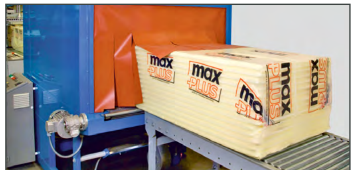
TRABAJAR CON TÚNEL TERMORETRACTIL
