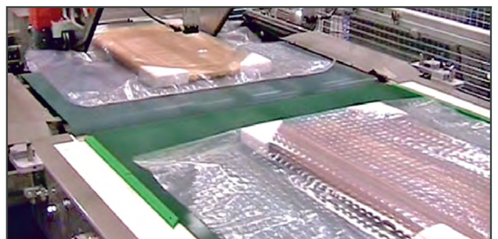
CERRADO TOTAL DEL PAQUETE ESTACIÓN SOLDADURA
